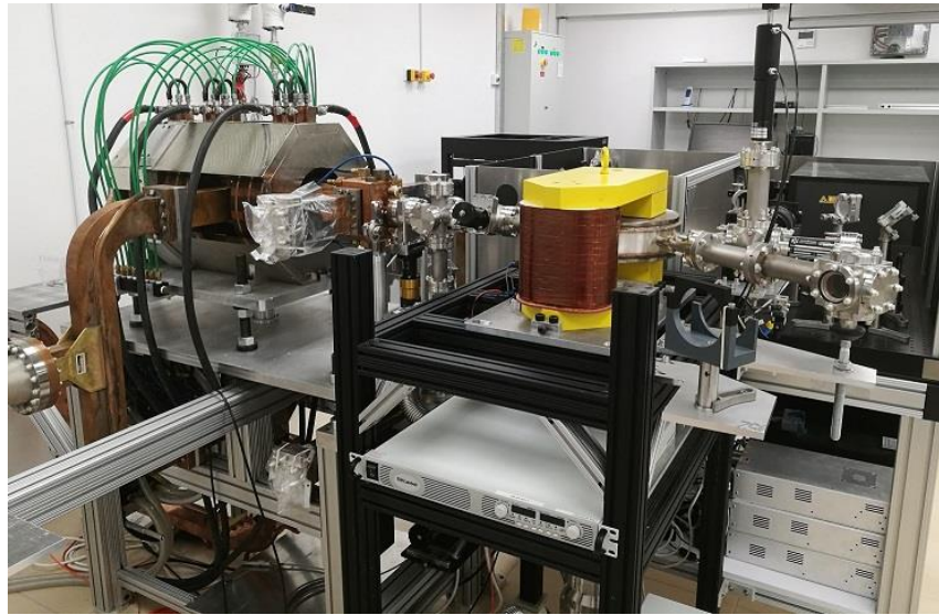
איור 11: מאיץ אורגד: Optically-pumped RF-Gun Accelerator Device
