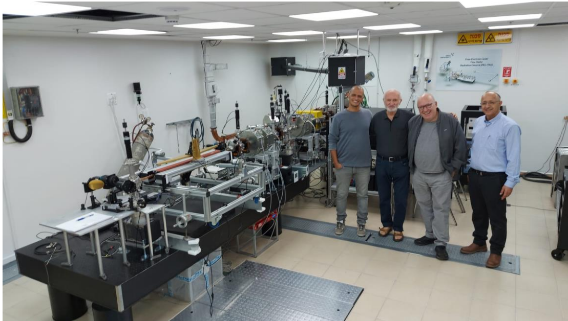
איור 16: מתקן Superradiant THz FEL הישראלי אוקטובר 2022. בקטע הרחוק מאיץ ,ORGAD, בקטע הקרוב Magnetic Wiggler ומוצא הקרינה. עומדים משמאל לימין: אריאל נעוס, אברהם גובר, אהרן פרידמן, יחיאל ושדי.
